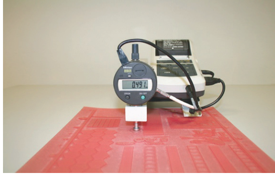
Şekil 10. Kalıbın Yükseklik Ölçümünün Yapılması
