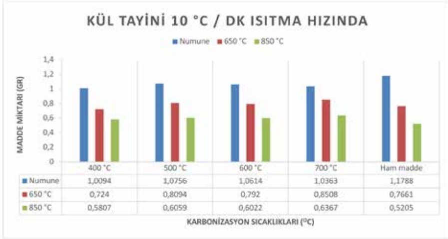
Şekil 2: 10 °C / dk ısıtma hızında kül tayini deney sonuçları
