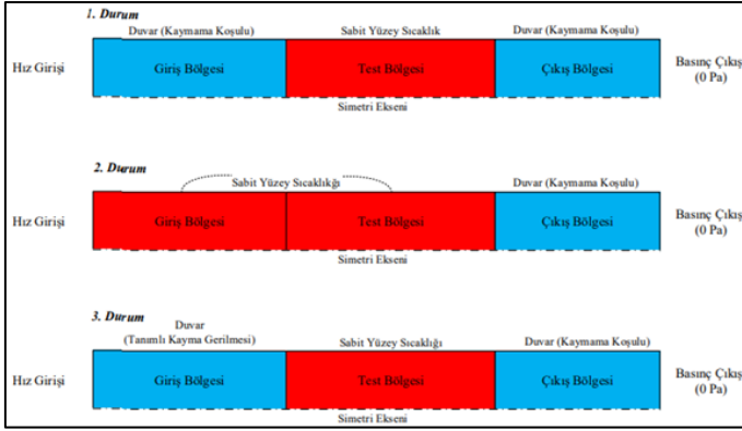
Şekil 1. Üç Durumun Sınır Şartlarının Şematik Gösterimi: 1. Durum Hidrodinamik Gelişmiş ve Isıl Gelişmekte; 2. Durum Hidrodinamik Gelişmiş ve Kısmen Isıl Gelişmiş; 3. Durum Hidrodinamik ve Isıl Gelişmekte
