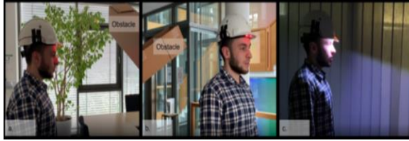
Şekil 4. a.b. Yönlü kırmızı LED ve kafa derisi haptik geri bildirim ile ön ve arka engel uyarısı. c. karanlık ortamda otomatik el feneri Kaynak: Aliyev vd., 2020
