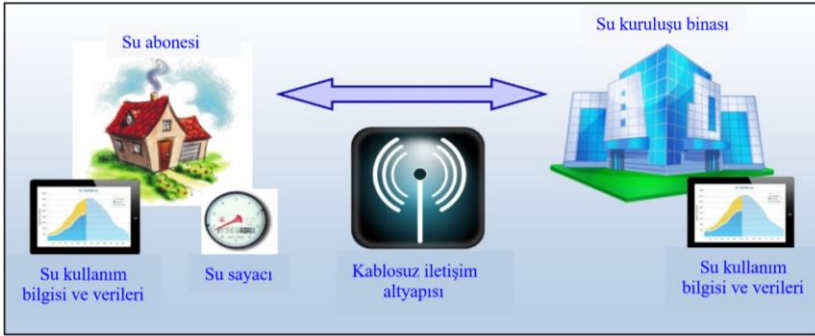
Şekil 1. AMR altyapısı ve akıllı sayaç teknolojisi Kaynak: Alliance for Water Efficiency, 2016
