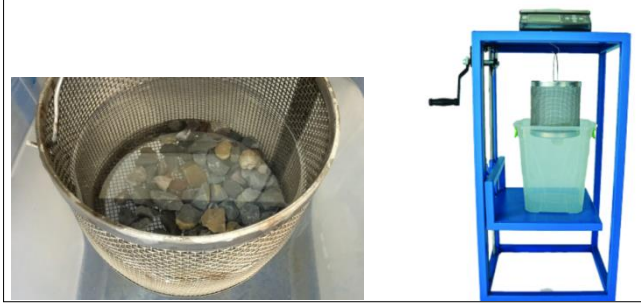
Şekil 10. Tane Yoğunluęu ve Su Emme Oranının Tayini Kaynak: ABT Lab., 2021.
