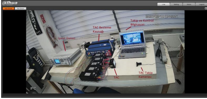
Şekil 3. Test yöneticisinin test düzenine uzaktan izlediği kameranın görüntüsü
