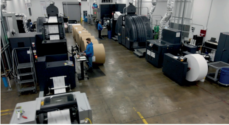
Şekil 20. Bobine baskı yapan inkjet gazete baskı makinesi (Ink World, 2023)
