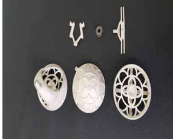
Görsel 23: Gümüş Döküm Yapılan Yüzük Parçaları.
