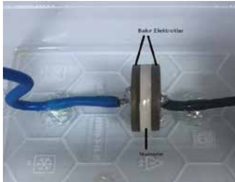
Şekil 7: AA analizi için test örneği yerleşimi.
