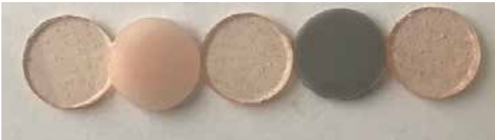
Şekil 3: %0.5 katkı oranındaki AA testi ölçüm numune serisi.
