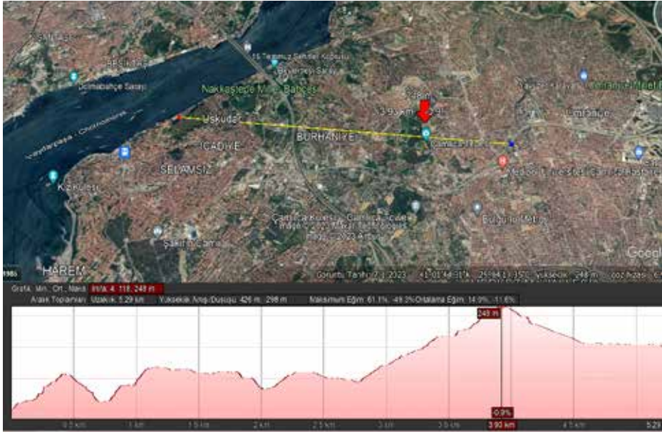
Şekil 4. Üsküdar'ın Çamlıca tepelerinden İstanbul Boğazı'na doğru eğim ve vadileri gösteren topoğrafik kesit 4 .
