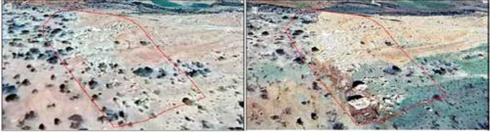
Şekil 10. DSİ Taş Ocağı deprem öncesi saha durumu (a) ve deprem sonrası (b) kaya ve moloz düşmeleri
