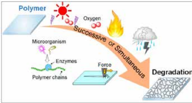
Şekil 3. Polyester yalıtkanlarda yüzey iz oluşumu degradasyon mekanizmasının şematik gösterimi[(An et al., 2024)].
