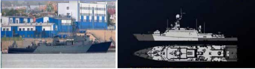
Görsel 13: (üstte). Rusya'nın Karadeniz Filosu amiral gemisi Amiral Makarov üzerinde, insansız deniz araçlarını (kamikaze İHA/SİDA) yanıltmak ve geminin boyutunu periskop/optik kameralarda daha küçük göstermek amacıyla pruva ve pupa kısımlarına uygulanan yeni nesil göz kamaştırıcı (dazzle) kamuflaj tasarımı. (Görsel: Global Defense Corp, 2023).
