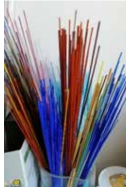
Görsel 27: Cam İplikler, 2-3mm Çap.
