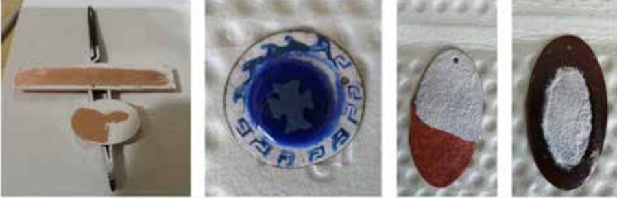
Görsel 36: Bakır Plaka Üzerine Başarısız Sıcak Mine Tekniği Örnekleri.
