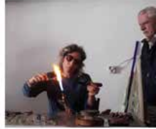
Görsel 53: Fatmir GÖLBAŞI Hoca Eşliğinde Borosilikat Cam Üfleme Tekniği “Helke” Üretimi
