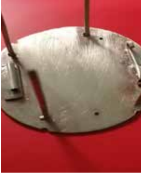
Görsel 43: Kaynak Yapılmış Pirinç Parça.
