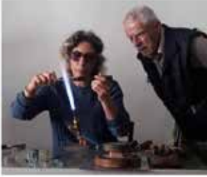
Görsel 53: Fatmir GÖLBAŞI Hoca Eşliğinde Borosilikat Cam Üfleme Tekniği “Helke” Üretimi
