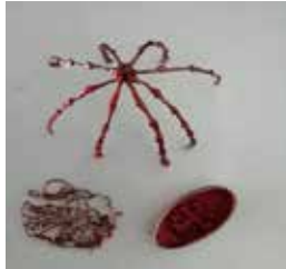
Görsel 24: UV Mine Uygulanmış Bakır Kaplamalı Plastik ve Mum Parçalar.
