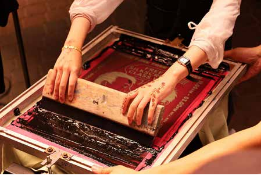
Şekil 2. Serigrafi Baskıda Rakle ile Boya Çekme İşlemi.
