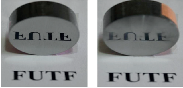
Şekil 9. Numunelerin elmas pastayla parlatma işleminden sonraki yansıma görüntüleri (22)
